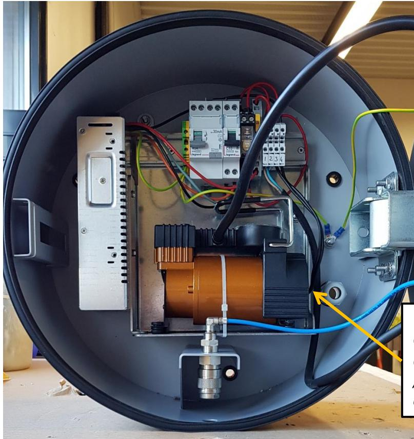
Bouton ON/OFF du compresseur sur le côté du compresseur
