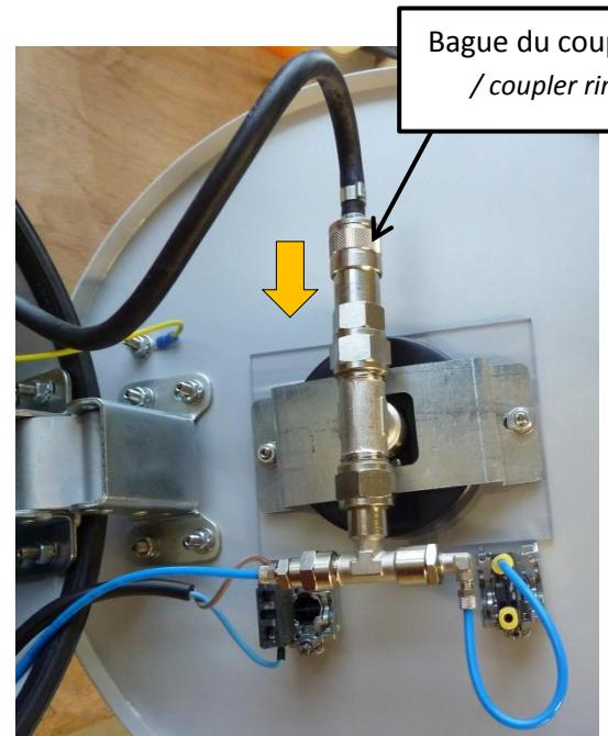
En cas de besoin, pour déclipser le flexible inox ou le flexible du compresseur, pousser le bas du coupleur vers les raccords et tirer sur le flexible
