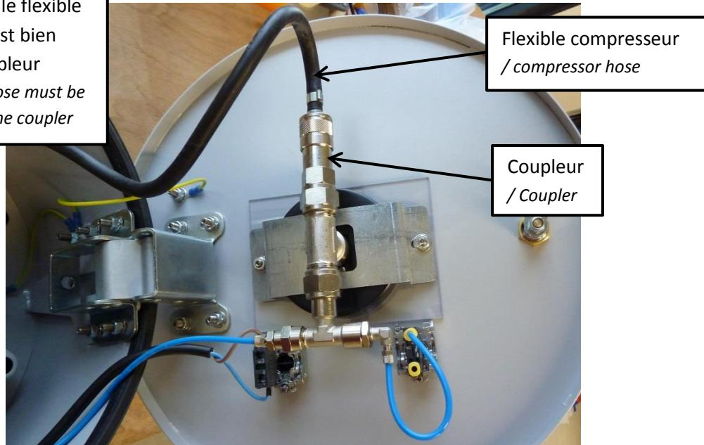
Mettre en place le flexible tressé inox extérieur en le clipsant dans le coupleur de sortie
