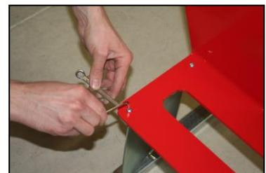
6. Positionner correctement votre rack. **S'il est face à un mur, positionner le rail à 17cm du mur.** Si 2 racks monolatéraux se suivent, il faut maintenir une distance de 50 cm entre les places voisines (entre la dernière place du rack n°1 et la première place du rack n°2)
